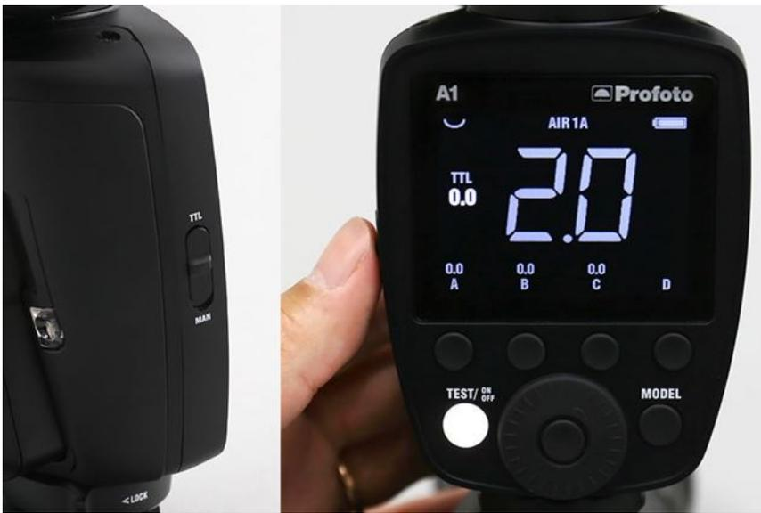
側面のスイッチでTTLとマニュアル発光を切り替えた際に、TTLの発光量を引き継ぐことが可能。一般的なクリップオンストロボではこうした機能は備わっておらず、マニュアル発光に切り替えると出力を再調整する必要がある
