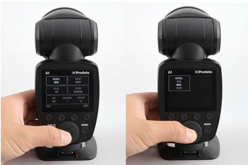
A1の操作は他のプロフォト製品と同様にシンプルでわかりやすい。メニュー操作は、液晶モニターに表示される内容を見ながら中央のダイヤルとボタンで選択する仕組みだ。視認性が高く、屋外でもモニターは見やすかった
