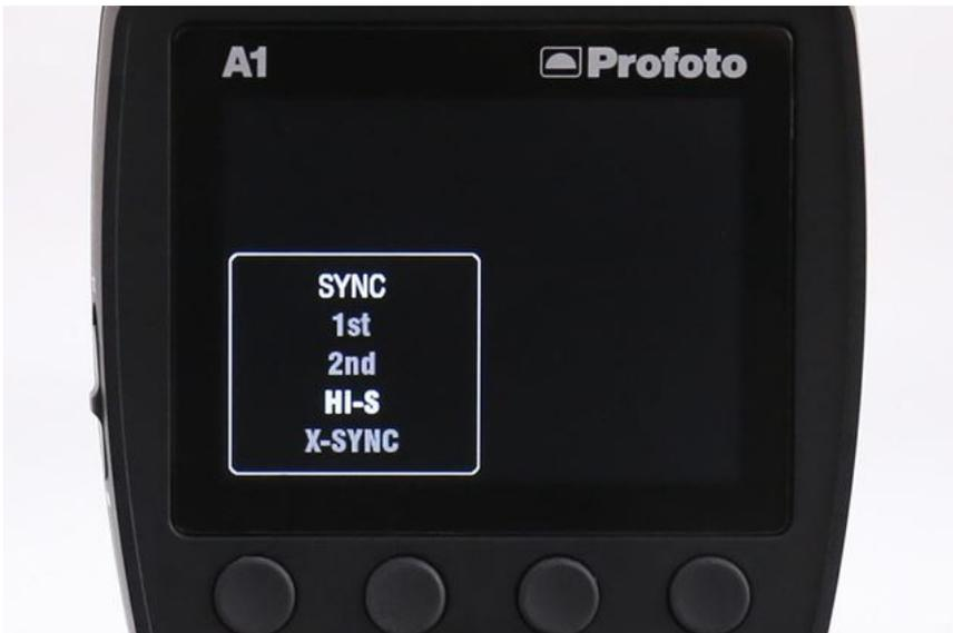
シンクロモードは1st（先幕）、2nd（後幕）、HI-S（ハイスピードシンクロ）、X-SYNCが用意されている。X-SYNCは、シンクロ接点が中央にあるホットシューであれば、他社用のA1を装着した場合でもマニュアル発光で動作できるモードだ（※TTLやHSSは使用できない）
