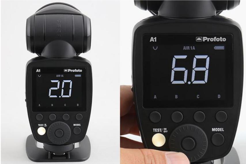
一般的なクリップオンストロボでは光量を表すのに1～1/256（1が最大値で1/256が最小値）といったように表示されるが、A1では他のプロフォト製品と同様の表記が用いられている。光量は2.0がもっとも弱く、10.0がもっとも強い。1.0ごとに明るさが絞り1段分変わる仕様だ。ダイヤルを回すことでダイレクトに光量を変更することができる
