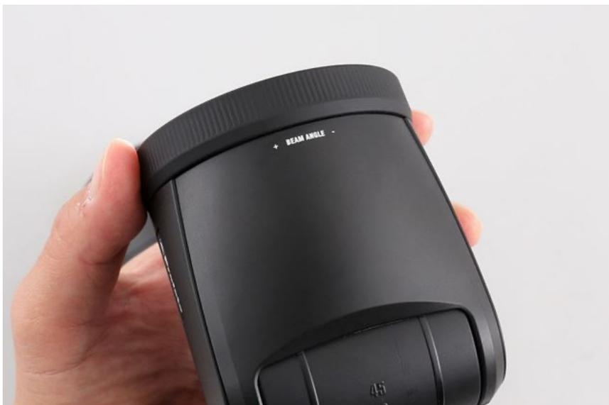
ズーム操作はヘッドのリングを回して行う。ズームは、手動で設定できるほか32~105mmの焦点距離に自動で対応。後述する付属オプションの「ワイドレンズ」を使えば14~24mmにも対応する。モニターに焦点距離が表示されないのが少々わかりにくいと感じたくらいで、操作にはすぐに慣れることができた
