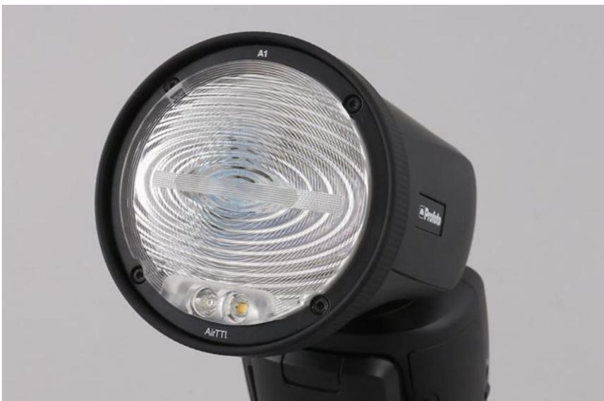
色温度は、一般的なスタジオライトの多くがそうであるように、デイライトの5500K前後に設計。クリップオンストロボは発光管が小さいため、デイライトよりも色温度が高くなる傾向がある。6000Kを超えるものが多く、環境光に合わせにくいところがあるが、5500K前後のA1ではそうした心配はない。スタジオライトと組み合わせる場合にも適した設計だ。
