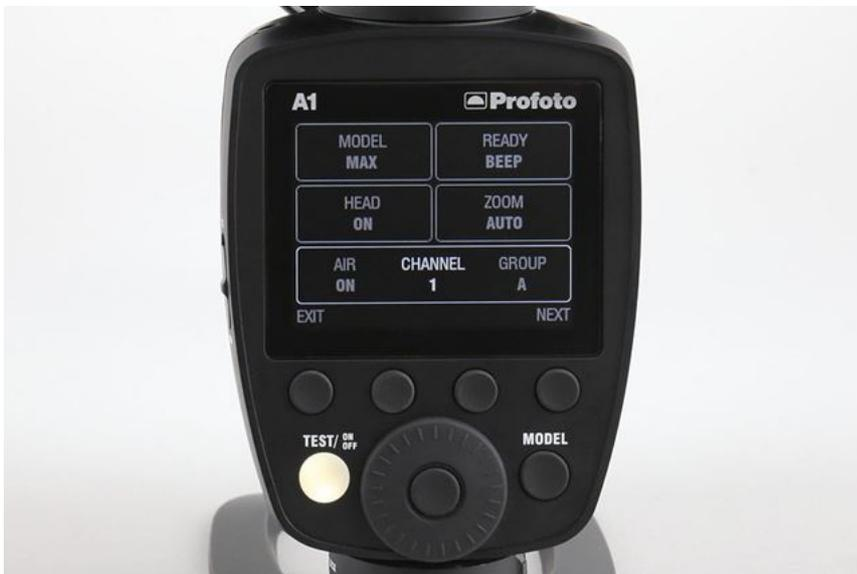
A1をAir Remoteのマスターとして使用することも可能。8つの無線チャンネルを設定でき、通常発光時は最大300m、TTL使用時は最大100mの距離で発光が行える。ストロボのグループ設定はA~Fに対応（A~CはTTL対応）。A1ではA~Dの4グループを手元で調整することができる
